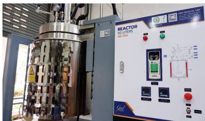
ระบบปฏิกรณ์เร่งดันสูงขนาด Bench-scale สำหรับสังเคราะห์ตัวเร่งปฏิกิริยาและวัสดุคูดซับนาโน
