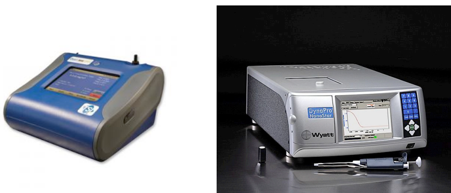
รูป A11.1: ตัวอย่างเครื่องวัดขนาดของอนุภาคด้วยวิธี Dynamic Light Scattering (DLS) ในอากาศ (ซ้าย) และในของเหลว (ขวา)
