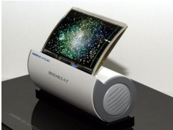
รูปที่ 2.2: จอคอมพิวเตอร์ชนิด OLED แบบแบนและโค้งได้
