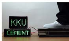
แหล่งกำเนิดไฟฟ้าแบบทริโบอิเล็กทริกจากวัสดุคอมโพสิตซีเมนต์
