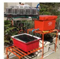
อุปกรณ์เทอร์โมอิเล็กทริกเพื่อเปลี่ยนพลังงานความร้อนจากแสงอาทิตย์เป็นพลังงานไฟฟ้า
