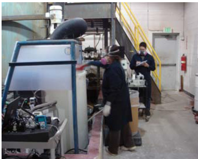
รูปที่ 3 การใช้ RPE สำหรับการเก็บตัวอย่างและการรวบรวมข้อมูลระหว่างการงานเกี่ยวกับการผสมวัสดุ (ข้อ 8.3.8.1)
