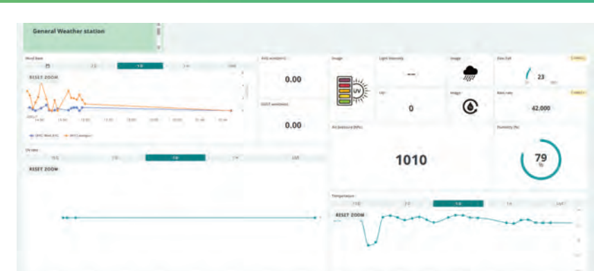
หน้า dash board แสดงข้อมูลสภาพอากาศที่สามารถตรวจวัดได้
